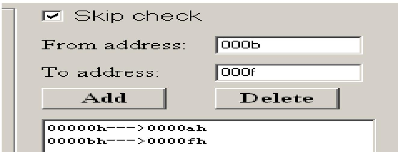
轉 CODE 的時候，由於義隆的 EMC78P153 和 EMC78P156 兩款 IC 的復位地址是 00H，而 feeling 的同規格的 IC 8PB/E53，8PB/E56 的復位地址是 03FFH，因此如果客戶寫的程式如果在 03FFH 這個位置上是 return，goto 等跳轉指令，程式轉換過來就很容易進入閉環導致程式轉換失敗，因此，我們在轉義隆的 153，156 的時候在 code 轉換過來之後，用遠翔的燒錄軟體打開之後看程式的 03FFH 那行是否跳轉指令，如果是的話，程式需適當的修改。
